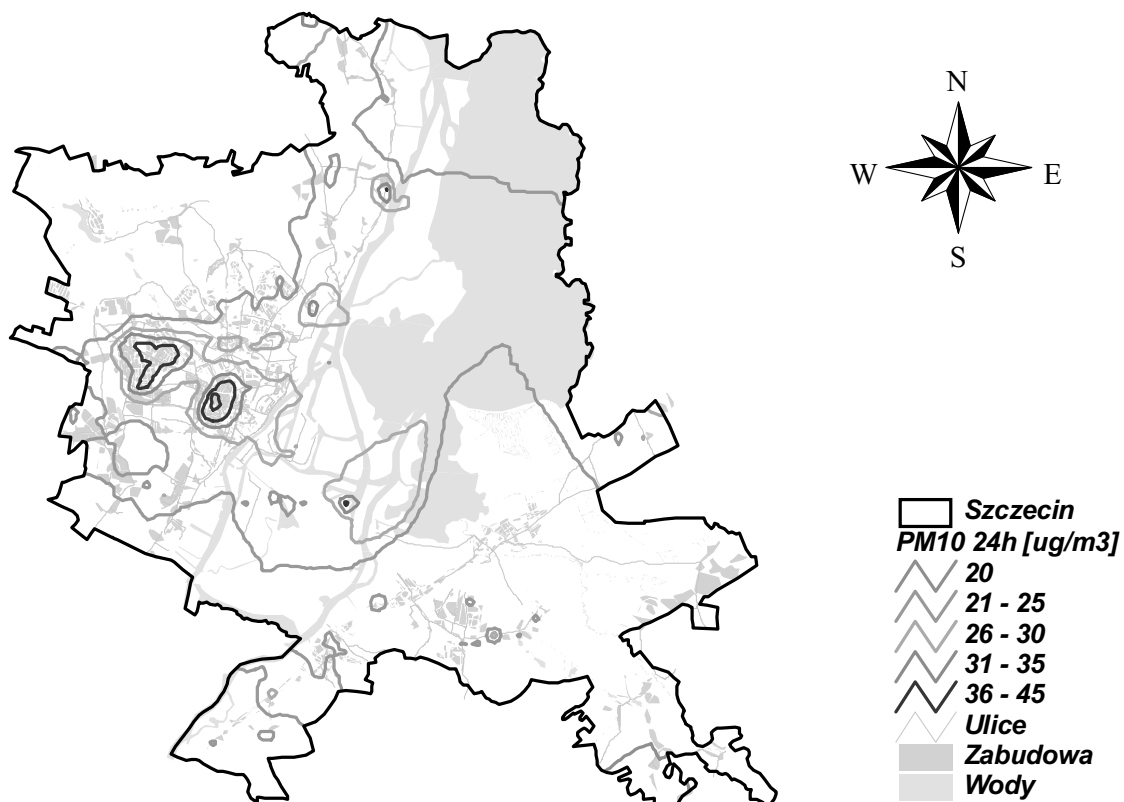
Rysunek 86 Rozkład stężeń PM_{10} 24h, pochodzących od całości emisji, po zastosowaniu wariantu 3
