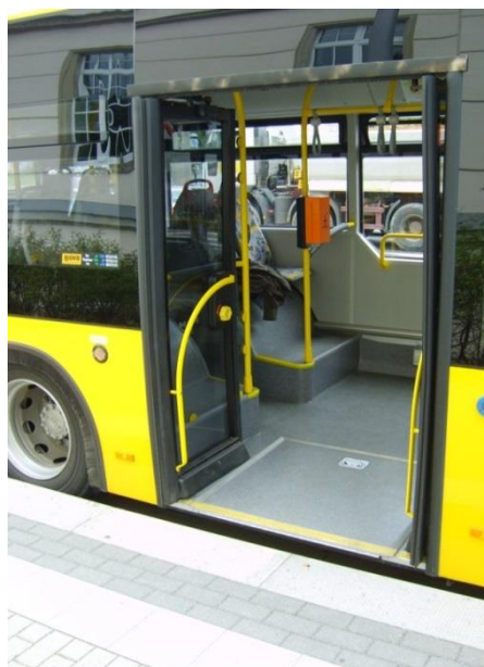
Rys. 9.8.2.2. Przerwa między peronem przystankowym a autobusem.
